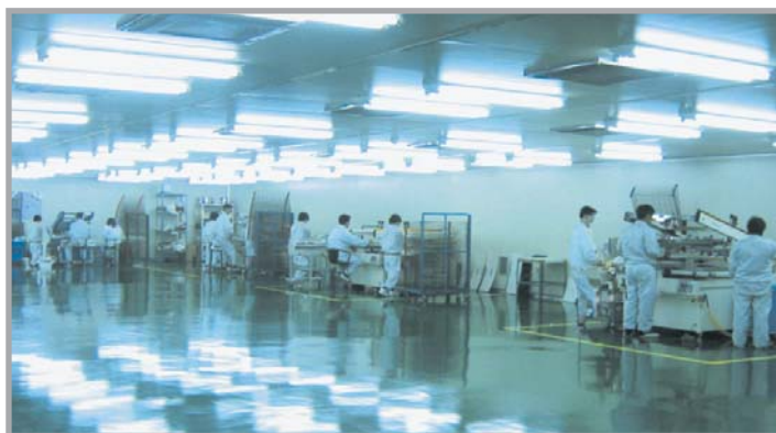
■ Clean Room(印刷室) 为提高产品质量，具备恒温、恒湿、Class 10,000的清洁度的System | 品質向上のために恒温、恒湿、Class10,000の清浄度を備えたシステム
