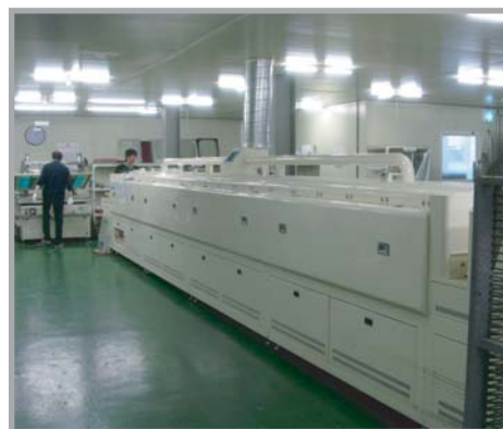
■ Clean Room(印刷室) 为提高产品质量，具备恒温、恒湿、Class 10,000的清洁度的System | 品質向上のために恒温、恒湿、Class10,000の清浄度を備えたシステム
