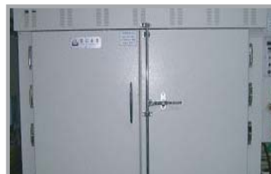
■ Clean Room(印刷室) 为提高产品质量，具备恒温、恒湿、Class 10,000的清洁度的System | 品質向上のために恒温、恒湿、Class10,000の清浄度を備えたシステム
