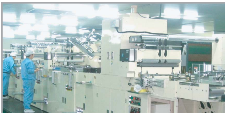
■ Roll to Roll 自动化设备 (IMD 及 IML 自动化 LINE) | 自動化設備 (IMD と IML の自動化ライン)
