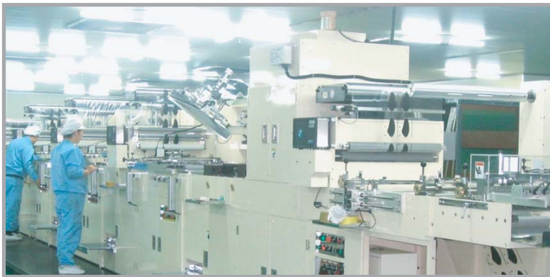
Roll to Roll 자동화 설비 (IMD 및 IML자동화 LINE) Roll to Roll Auto Print machine
